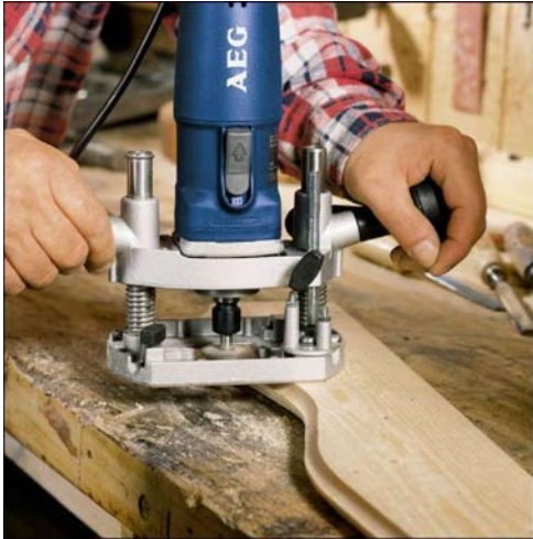
Feuillurage avec un guide parallèle
