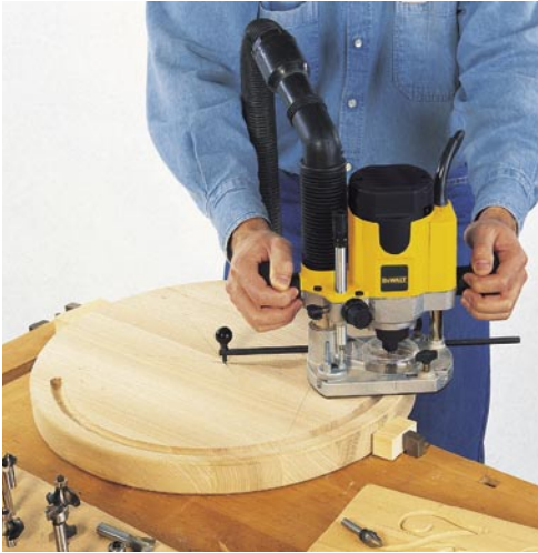
Certaines machines sont livrées avec un compas pour profiler des pièces rondes.
