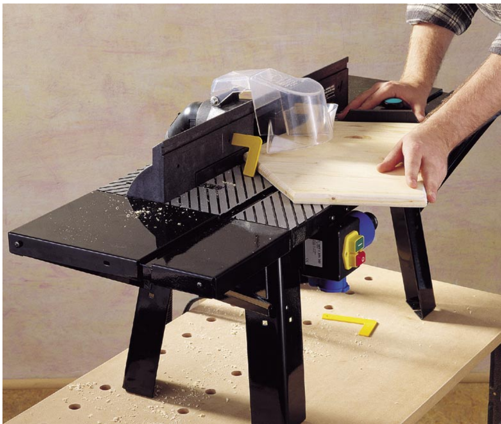
La défonceuse est transformable en toupie grâce à une table d'usinage.
